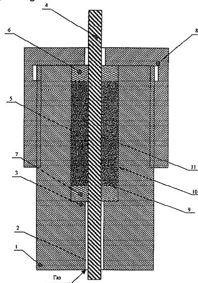
Заявляемое изобретение относится к электротехнике, а именно к уплотнениям проводников, герметичным вводам, и может быть использовано для подвода энергии в электротехнические установки, при изготовлении герметичных химических источников тока, работающих при высокой температуре.
