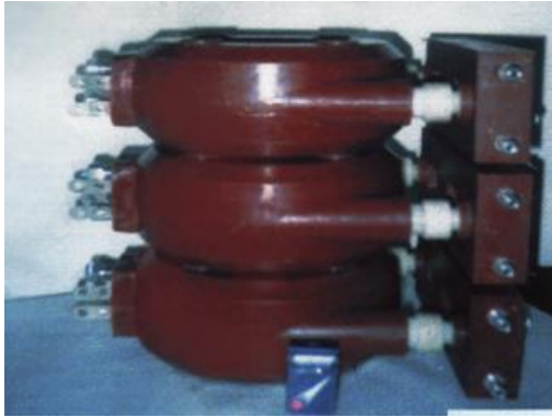
Трансформаторно-выпрямительный блок 40 кВ, 200 кВт, 6-8 кГц
