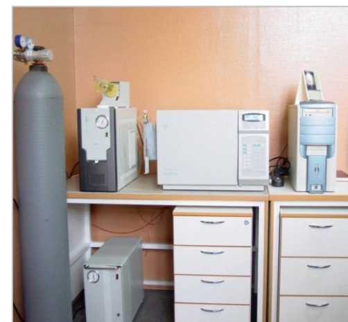
Хроматографический комплекс «КРИСТАЛЛ 2000М» (ХРОМАТЭК)
